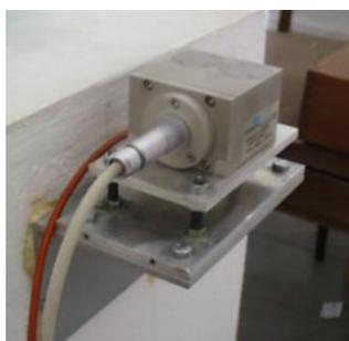
Figura 2 – Clinómetro colocado numa poleia
