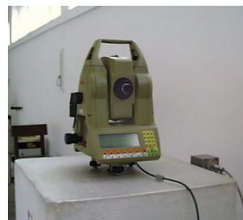
Figura 3 – Taqueómetro Leica TCA2003
