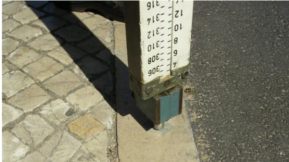
Figura 2 – Estacionamento de uma mira de 3 m, com escala em invar, na marca 136L2
