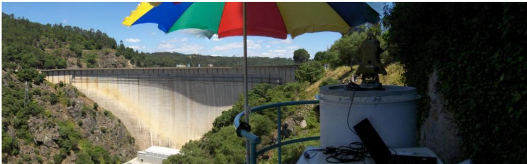
Figura1 – Barragem do Cabril: taqueómetro electrónico motorizado LEICA TCA 2003
